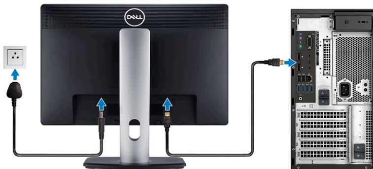
**i** **NOTA:** Si se realizó el pedido del equipo con una tarjeta gráfica discreta, el puerto HDMI y los puertos en el panel posterior del equipo estarán cubiertos. Conecte la pantalla a la tarjeta gráfica discreta.
